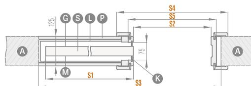
Épaisseur du caisson avant la pose des plaques de plâtre cartonné - 100 mm
