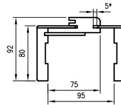
\* La coupe du dormant 075-095 est différente, pour des épaisseurs de cloison de 75-89 mm, il sera nécessaire de raccourcir la languette de la cornière mobile par vos soins.
