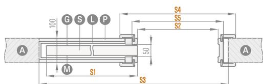
Épaisseur du caisson avant la pose des plaques de plâtre cartonné – 75 mm
