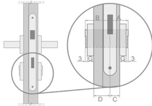
Cylindres dans le système à clé unique 30/45 + 30G/45 portes ouvrant vers l'extérieur – argent, noir
