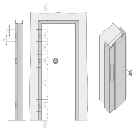
**A** Faites des trous pour les vis métalliques d'une longueur minimale de 80 mm x 6mm.
